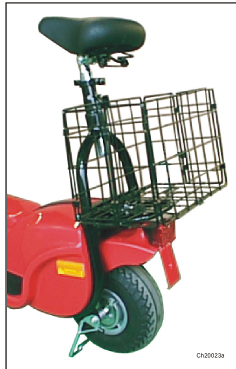
Bild 2 Gepäckträger, im Bild mit dem als Zubehör lieferbaren, faltbaren Gepäckkorb
